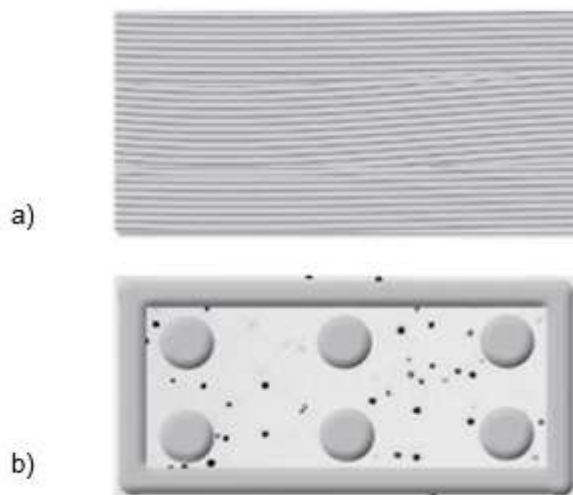
Ilustracja 4. Sposoby nakładania kleju Termo Organika® TO-KS, Termo Organika® TO-KU lub Termo Organika® TO-KUB
